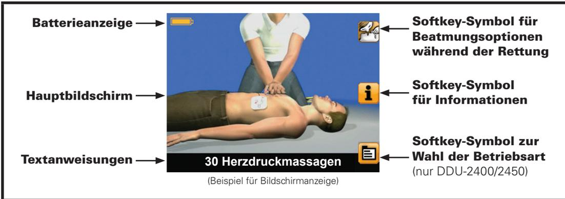
**Batterieanzeige** – Die Batterieanzeige zeigt die ungefähre verbleibende Batteriekapazität an.
