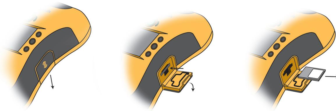
Vor der Entnahme der DDC-Karte sicherstellen, dass der AED ausgeschaltet ist. Die Zugangsklappe für Datenkarte und USB-Anschluss befindet sich auf der rechten Seite des Geräts. Entriegeln Sie die Zugangsklappe durch leichtes Drücken und anschließendes Herunterschieben. Die Klappe springt auf. Um die DDC-Karte zu entfernen, drücken Sie die Karte soweit wie möglich hinein und lassen Sie sie dann los. Dadurch wird die DDC-Karte teilweise ausgeworfen und kann dann vollständig herausgezogen werden.
